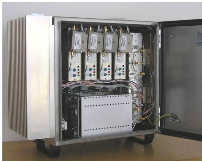
Le répéteur est livré réglé sur les fréquences demandées par le client, et en option, il peut être contrôlé à distance. Le répéteur BX 252 est idéal pour utilisation sur des réseaux TETRA.
